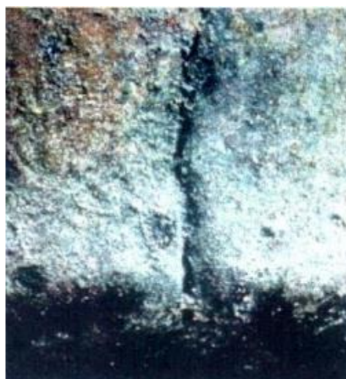
نوع ترکیدن بوته در قسمت تحتانی به دلیل حرارت دهی مجدد به مذاب سرد و منجمد شده
