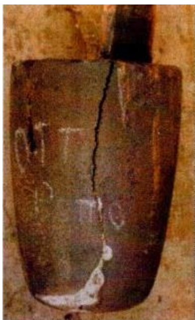
شکستگی به دلیل حرارت و انبساط مجدد فلز جامد شده
