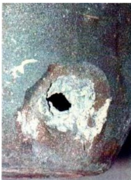
سوراخی که به دلیل انداختن شمش به داخل بوته ایجاد شده است
